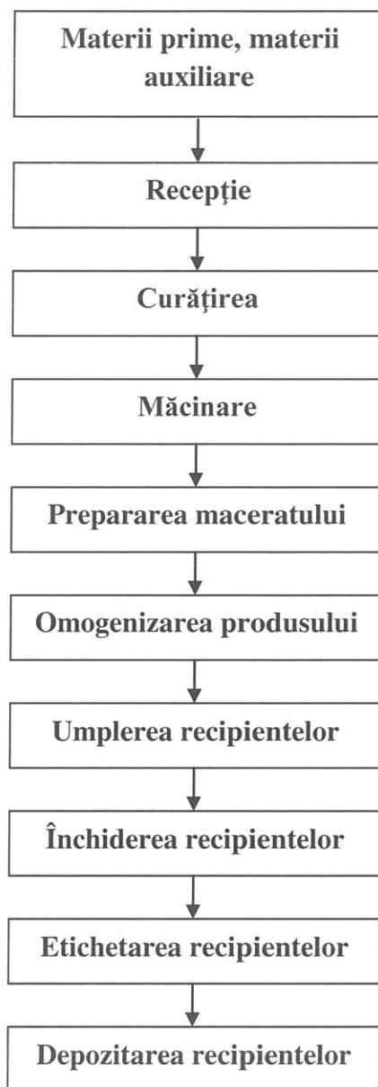
Schema tehnologică de fabricare a muștarului
